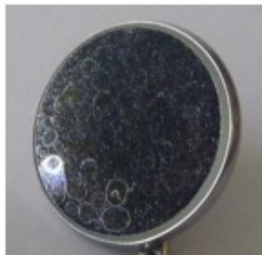
Photo 4 Taches de calcaire
