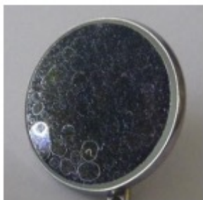
Slika 4 Madeži vodnega kamna
