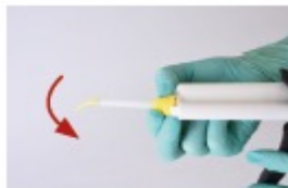
SLIKA 5 Prepričajte se, da se zareze na mešalni konici ujemajo z zarezi na kartuši. Močno pritisnite, da vstavite mešalno konico. Nato mešalno konico obrnite za 90 stopinj v smeri urnega kazalca, da se zaskoči. Mešalna pištola je zdaj pripravljena za uporabo.
