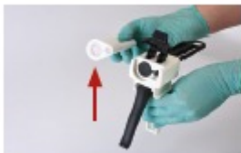
FIGURA 2 e 3 Sollevare la levetta di plastica per inserire la cartuccia. Importante: assicurarsi che le tacche sulla cartuccia corrispondano a quelle sulla pistola. In seguito bloccare la cartuccia spingendo la levetta di plastica verso il basso.
