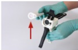
OBRÁZEK 2 a 3 Zvedněte plastovou páčku na horní straně, abyste mohli vložit kartuši. Důležité: Dbejte na to, aby zářezy na kartuši lícovaly se zářezy na míchací pistolí. Poté kartuši zajistíte zatlačením plastové páčky zpět dolů.
