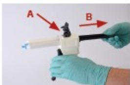
OBRÁZEK 6 a 7 Chcete-li kartuši vyjmout, zatlačte odjišťovací páčku míchací pistole směrem nahoru. (A) Vytáhněte šoupátko zcela dozadu. (B) Nastavte západku kartuše do horní polohy a vytáhněte páčku kartuše směrem nahoru, abyste mohli kartuši vyjmout.
