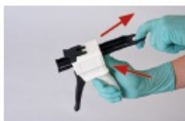
BILD 6 och 7 Lossa patronen genom att trycka på låsningsspaken på blandningspistolen uppåt. (A) Kör in skenan helt. (B) Kontrollera att låsningen för patronen är i sin övre position och dra spaken för patronen uppåt för att lossa patronen.
