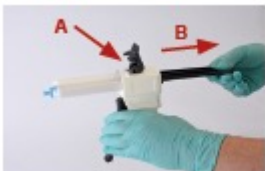
IMAGE 6 ET 7 Pour retirer la cartouche, pousser le levier de déverrouillage du pistolet de mélange vers le haut. (A) Faire rentrer entièrement le rail. (B) Placer le verrouillage de cartouche en position supérieure et tirer le levier de la cartouche vers le haut pour retirer la cartouche.
