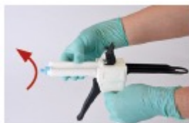
KUVA 4 Kun haluat asettaa sekoitusjärjen paikalleen, poista patruunan suojaus kääntämällä suojusta 90° vastapäivään ja vetämällä sen sitten irti. Voit säilyttää suojuksen ja sulkea patruunan sillä jälleen uudelleen, jos patruunan sisältöä ei käytetä kokonaan.
