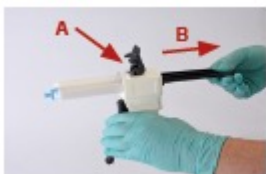
PILDID 6 ja 7 Kasseti eemaldamiseks suruge segamispüstoli vabastushooba üles. (A) Liigutage siin täiesti sisse. (B) Seadke kassetilukusti ülemisse asendisse ja tõmmake kassetihoob täiesti üles, et võtta kasset välja.
