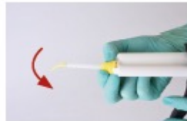
IMAGE 5 s'assurer que les encoches au niveau de l'embout mélangeur correspondent à celles de la cartouche. Appuyer fermement pour emboîter l'embout mélangeur. Tourner ensuite l'embout mélangeur à 90° dans le sens horaire jusqu'à son enclenchement. Le pistolet de mélange est maintenant prêt à l'emploi.
