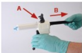
SLIKI 6 in 7 Če želite odstraniti kartušo, potisnite sprostitveni vzvod mešalne pištole navzgor. (A) Vodilo popolnoma izvlecite. (B) Postavite zaklep kartuše v zgornji položaj in potegnite vzvod kartuše navzgor, da odstranite kartušo.
