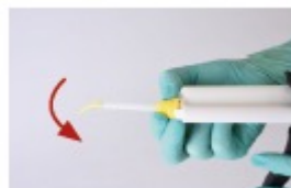
FIG 5 Sørg for, at indhakkene på Mixing Tip matcher de indhak, der sidder på patronen. Tryk hårdt for at indsætte Mixing Tip. Drej derefter Mixing Tip 90 grader med uret, indtil den går i indhak igen. Blandepistolen er nu klar til brug.
