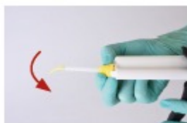
FIGURA 5 Assicurarsi che le tacche sulla punta di miscelazione corrispondano a quelle sulla cartuccia. Tenere premuto per applicare la punta. Infine ruotare la punta di miscelazione di 90 gradi in senso orario finché scatta. La pistola miscelatrice è ora pronta all'uso.
