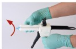
FIGURA 4 Per applicare la punta di miscelazione, eliminare il cappuccio della cartuccia ruotando il cappuccio in senso antiorario per 90 gradi, poi rimuoverlo. È possibile conservare il cappuccio per chiudere di nuovo la cartuccia nel caso in cui il contenuto non venga utilizzato completamente.
