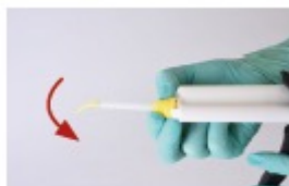
BILD 5 Stellen Sie sicher, dass die Einkerbungen an dem Mixing Tip mit denen an der Kartusche übereinstimmen. Um den Mixing Tip einzusetzen bitte fest drücken. Drehen Sie anschließend den Mixing Tip um 90 Grad im Uhrzeigersinn, bis dieser einrastet. Die Mischpistole ist jetzt einsatzbereit.
