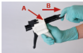
BILD 1 Drücken Sie den Hebel an der Rückseite der Mischpistole nach oben (A) und ziehen Sie den Schieber vollständig zurück (B).
