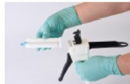
BILD 2 und 3 Heben Sie den Kunststoffhebel an, um die Kartusche einzusetzen. Wichtig: Stellen Sie sicher, dass die Einkerbungen an der Kartusche mit denen an der Mischpistole übereinstimmen. Danach verriegeln Sie diese, indem Sie den Kunststoffhebel zurück nach unten drücken.
