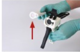
IMAGE 2 et 3 Lever le levier plastique pour insérer la cartouche. Important : s'assurer que les encoches sur la cartouche correspondent à celles du pistolet de mélange. Puis, la verrouiller en abaissant le levier plastique.
