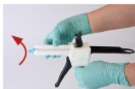
OBRÁZEK 4 Chcete-li nasadit míchací špičku Mixing Tip, sejměte uzávěr kartuše tak, že jej otočíte o 90 stupňů proti směru hodinových ručiček a poté jej sejmete. Pokud jste obsah kartuše zcela nepotřebovali, můžete si uzávěr ponechat a kartuši opět uzavřít.
