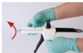
FIG 4 For at indsætte Mixing Tip skal patronens hætte fjernes ved at dreje den 90 grader mod uret og derefter trække den af. Du kan opbevare hæften for at lukke patronen igen, hvis indholdet ikke er brugt helt op.
