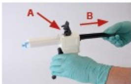
FIGUR 6 og 7 For å ta ut patronen trykker du utløsserspaken på blandepistolen oppover. (A) Trekk skinnen helt inn. (B) Sett patronlåsen i øvre posisjon og trekk kassettpaken oppover for å ta ut patronen.
