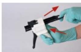
BILD 6 und 7 Um die Kartusche zu entfernen drücken Sie den Entriegelungshebel der Mischpistole nach oben. (A) Die Schiene vollständig einfahren. (B) Stellen Sie die Kartuschenverriegelung in die obere Position und ziehen Sie den Hebel der Kartusche nach oben, um die Kartusche zu entnehmen.
