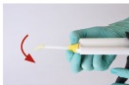
OBRÁZEK 5 Dbejte na to, aby zářezy na míchací špičce Mixing Tip lícovaly se zářezy na kartuši. Při nasazování na míchací špičku Mixing Tip silně zatlačte. Poté otočte míchací špičku Mixing Tip o 90 stupňů ve směru hodinových ručiček, aby zapadla na své místo. Míchací pistole je nyní připravena k použití.
