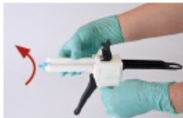
IMAGE 4 Pour emboîter l'embout mélangeur, retirer le capuchon de cartouche en le tournant de 90 degrés dans le sens anti-horaire avant de le retirer. Il est possible de conserver le capuchon pour refermer la cartouche si le contenu n'est pas épuisé.
