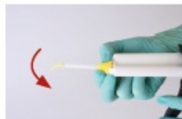
KUVA 5 Varmista, että sekoitusjärjen lovet ovat kohdakkain patruunan lovien kanssa. Aseta sekoitusjärki paikalleen tiukasti painaen. Käännä sekoitusjärkeä sitten 90° myötäpäivään, kunnes se lukkiutuu. Sekoituspistooli on nyt käyttövalmis.
