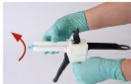
PILT 4 Segamisotsaku kasutamiseks eemaldage padrungi kork. Selleks pöörake korki päripäeva 90 kraadi ja tõmmake kork seejärel ära. Korki võib alles hoida, et kasseti uuesti sulgeda, kui sisu ei tarvitatud täielikult ära.
