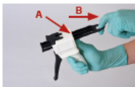
SLIKA 1 Potisnite vzvod na zadnji strani mešalne pištole navzgor (A) in potegnite drsnik povsem nazaj (B).
