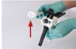
PILDID 2 ja 3 Kasseti kasutamiseks tõstke plasthoob üles. NB! Veenduge, et kassetil olevad sälgud langevad kokku segamispüstolil olevate sälkudega. Seejärel lukustage see asend, surudes plasthoova alla
