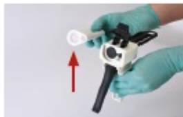
FIG 2 og 3 Løft plasthåndtaget for at sætte patronen i. Vigtigt: Sørg for, at indhakkene på patronen matcher til de indhak, der sidder på blandepistolen. Derefter fastlåses den ved at skubbe plastikhåndtaget ned igen.
