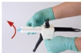
SLIKA 4 Če želite vstaviti mešalno konico, odstranite pokrovček kartuše tako, da ga obrnete za 90 stopinj proti smeri urnega kazalca, nato pa ga povlecite dol. Pokrovček lahko shranite, da ponovno zaprete kartušo, če vsebina ni bila v celoti porabljena.
