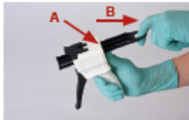
KUVA 1 Työnnä sekoituspistoolin takaosassa olevaa vipua ylöspäin (A) ja vedä työnnin kokonaan taaksepäin (B).
