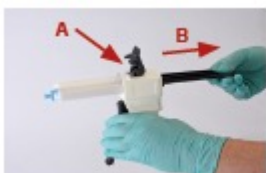
BILD 6 och 7 Lossa patronen genom att trycka på låsningsspaken på blandningspistolen uppåt. (A) Kör in skenan helt. (B) Kontrollera att låsningen för patronen är i sin övre position och dra spaken för patronen uppåt för att lossa patronen.
