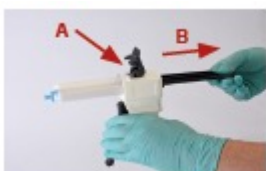
BILD 6 und 7 Um die Kartusche zu entfernen drücken Sie den Entriegelungshebel der Mischpistole nach oben. (A) Die Schiene vollständig einfahren. (B) Stellen Sie die Kartuschenverriegelung in die obere Position und ziehen Sie den Hebel der Kartusche nach oben, um die Kartusche zu entnehmen.
