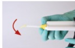
PILT 5 Veenduge, et segamisotsakul olevad sälgud on kassetil olevate sälkudega kohakuti. Segamisotsaku kasutamiseks hoidke sellest tugevasti kinni. Seejärel pöörake segamisotsakut 90 kraadi päripäeva, kuni otsak fikseerub. Segamispüstol on nüüd kasutusvalmis.
