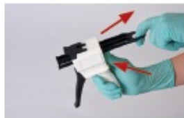
IMAGE 6 ET 7 Pour retirer la cartouche, pousser le levier de déverrouillage du pistolet de mélange vers le haut. (A) Faire rentrer entièrement le rail. (B) Placer le verrouillage de cartouche en position supérieure et tirer le levier de la cartouche vers le haut pour retirer la cartouche.
