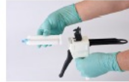
IMAGE 2 et 3 Lever le levier plastique pour insérer la cartouche. Important : s'assurer que les encoches sur la cartouche correspondent à celles du pistolet de mélange. Puis, la verrouiller en abaissant le levier plastique.
