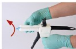
BILD 4 Um den Mixing Tip einzusetzen entfernen Sie die Patronenkappe, indem Sie die Kappe gegen den Uhrzeigersinn um 90 Grad drehen, und ziehen Sie sie dann ab. Sie können die Kappe aufbewahren, um die Kartusche wieder zu verschließen, sollte der Inhalt nicht vollends verbraucht worden sein.
